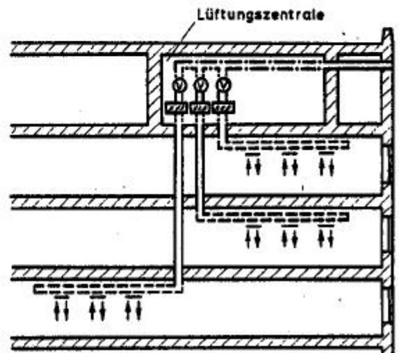
Bild 6 und 7: ... getrennte Ventilatoren
