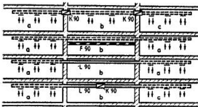
Bild 13: Überbrückung von Brandwänden und Heizraumwänden
