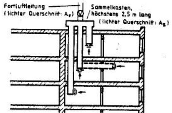
**Bild 20:** Zentrallüftungsanlage nach DIN 18017 Teil 3 mit getrennten Hauptleitungen
