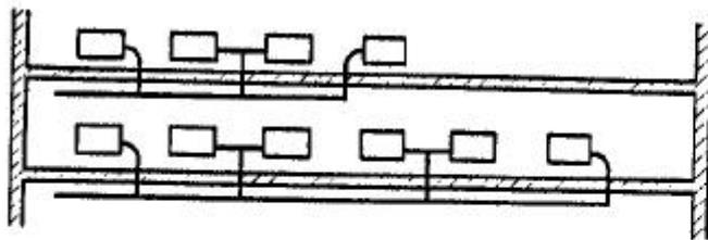
Bild 15: ... waagerechte Verteilung im darunterliegenden Geschoß
