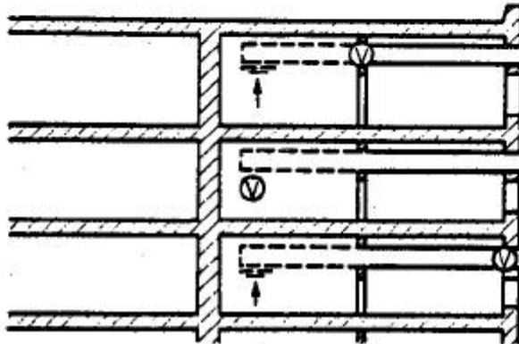
**Bild 19:** Einzellüftungsanlagen mit Ventilatoren innerhalb desselben Geschosses, die keine Trennwände oder Flurwände überbrücken, an die Anforderungen hinsichtlich der Feuerwiderstandsdauer gestellt sind
