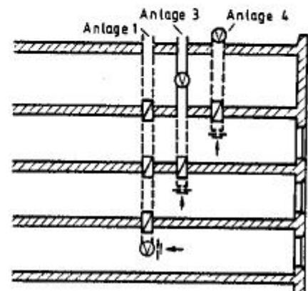
Bild 18: Entlüftungsanlagen mit getrennten Hauptleitungen und Absperrvorrichtungen für Lüftungsanlagen entsprechend DIN 18017 Teil 3
