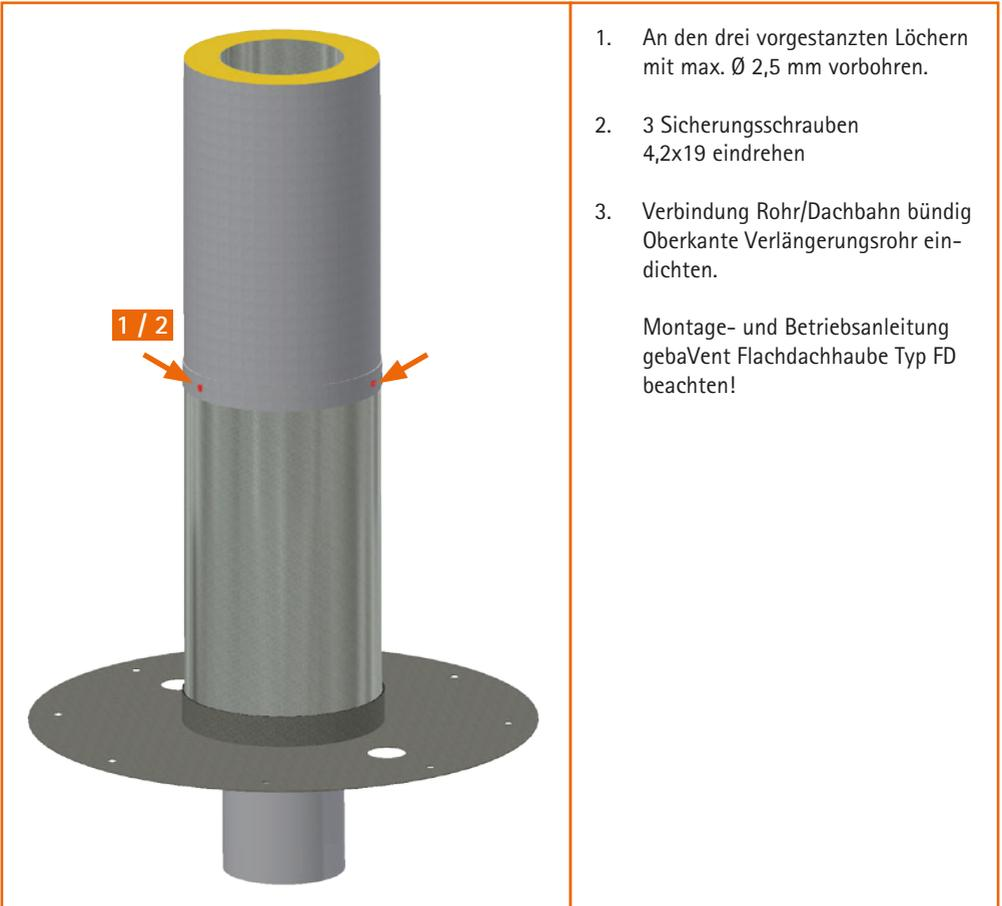
1. An den drei vorgestanzten Löchern mit max.  $\varnothing$  2,5 mm vorbohren.
